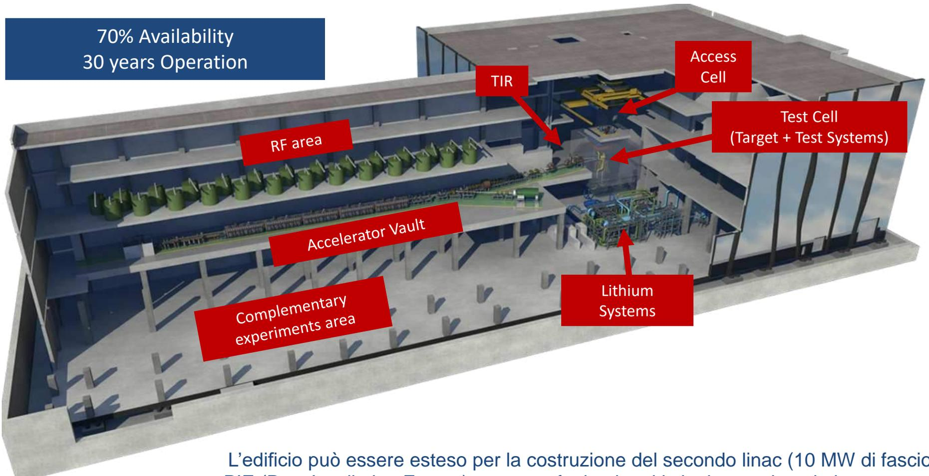
L'edificio può essere esteso per la costruzione del secondo linac (10 MW di fascio)
